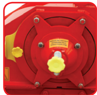
Afiador rotativo das facas do rotor picador
