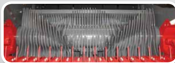
ULTRACUT CON 25 CUCHILLAS
