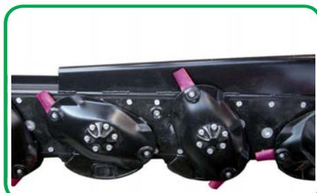
Coltelli sagomati in acciaio con sgancio agevole mediante bulloni • Shaped steel blades with bolts to make them easier to release • Couteaux façonnés en acier à décrochage rapide par boulons • Formstahlmesser mit durch Schraubbolzen vereinfachter Ausrüstung • Cuchillas molduradas de acero con desenganche cómodo mediante bulones
