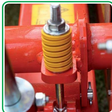
Tendinghia automatico a molla • Tensioners automatic spring • Tendeurs automatiques de printemps • Abspannungen automatische Frühjahr • Tensores automáticos primavera
