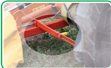
Sistema di sicurezza per arretramento della barra contro gli ostacoli • Safety system that retracts the bar when obstructions are encountered • Système de sécurité pour reculer la barre en cas d'obstacles • Sicherheitssystem zum Einziehen des Mähwerks beim Stoß gegen Hindernisse • Sistema de seguridad para la retracción de la barra contra los obstáculos
