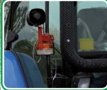
Dispositivo ad ultrasuoni per la protezione della selvaggina • Ultrasonic device for the protection of wild animals • appareil à ultrasons pour la protection des animaux • Ultraschall-Gerät für den Schutz der wild lebenden Tiere • dispositivo de ultrasonidos para la protección de animales salvajes
