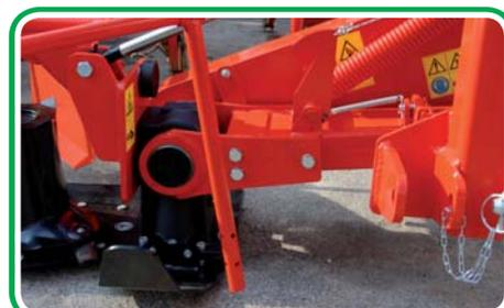
Moltiplicatore e barra in bagno d'olio • Oil-cooled overdrive and bar • Multiplicateur et barre à bain d'huile • Übersetzungsgetriebe und Balken im Ölbad • Multiplicador y barra en baño de aceite
