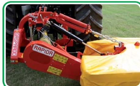
Falciatrice dotata di dispositivo ammortizzatore dei moduli telaio/barra con doppia molla di alleggerimento • Mower with shock-absorber for the frame/bar modules plus double lightening spring • Fauchese équipée de dispositif amortisseur des modules châssis/barre à double ressort d'allègement • Mähwerk mit Stoßdämpfer der Module Rahmen/Balken mit doppelter Entlastungsfeder • Cortadora con dispositivo amortiguador de los módulos bastidor/barra con doble resorte de alivianado
