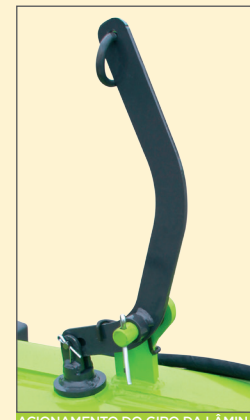
ACIONAMENTO DO GIRO DA LÂMINA MANUAL = STANDARD HIDRÁULICO = OPCIONAL
