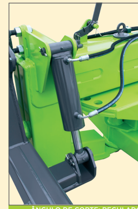
ÂNGULO DE CORTE: REGULADO ATRAVÉS DO COMANDO HIDRÁULICO 25°
