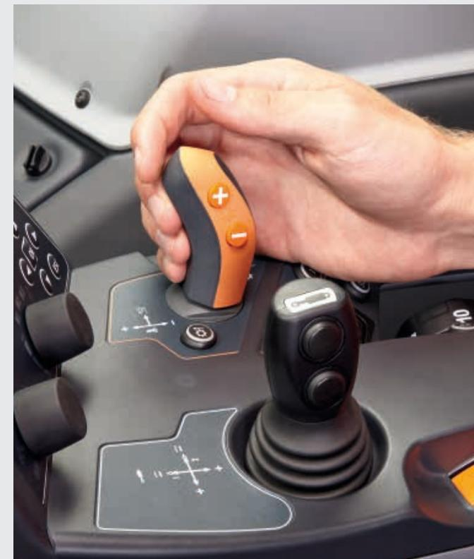
A transmissão Powershift disponibiliza quatro gamas, duas gamas de velocidade “creeper” e 30 velocidades em ambas as direcções. A nova alavanca das velocidades, com os modos manual e automático, permite realizar as mudanças de velocidade sem esforço e com precisão. O sistema hidráulico com sensor de carga e a assistência hidráulica fazem dos tractores da série T os melhores tractores com powershift de sempre.
