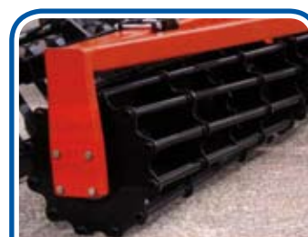
Rullo GABBIA Ø 600 Rinforzato - 12 tubi CAGE roller Ø 600 Reinforced - 12 tubes Rouleau CAGE Ø 600 Renforcé - 12 tubi
