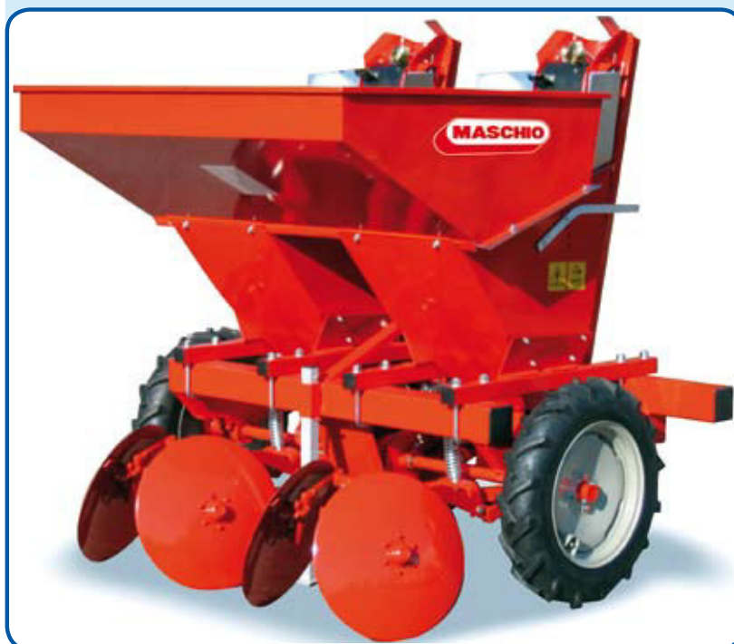
Kegelförmige, höhenverstellbare Scharen. - Rejas surcadoras en forma de cuña regulables en altura. - Relhas sulcadoras em forma de deflector regulável em altura.
