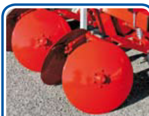
Einstellbare Abdeckscheiben mit Teleskopfeder. - Discos de cobertura regulables con resorte telescópico. - Discos cobridores reguláveis com mola telescópica.
