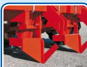
Kegelförmige, höhenverstellbare Scharen. - Rejas surcadoras en forma de cuña regulables en altura. - Relhas sulcadoras em forma de deflector regulável em altura.
