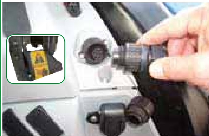
Direktanschluss an Radar über 7-poliges Kabel - Conexión directa al radar con cable de 7 polos - Conexão directa ao radar por meio de cabo de 7 pólos
