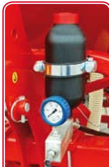
Hydraulische schwingende Seitenflügel mit Speicher zum Schwingungsausgleich für maximale Haftung am Bodenprofil Alas laterales flotantes hidráulicas con acumulador de compensación para obtener la máxima adherencia al perfil del terreno Asas laterais flutuantes hidráulicas com acumulador de compensação para proporcionar a máxima aderência ao perfil do terreno
