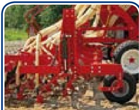
Schwingflügel mit einstellbaren Tragrädern Alas flotantes con ruedas de soporte regulables Asas flutuantes com rodas de sustentação ajustáveis
