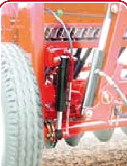
Hydraulische Spannung des Säbalkens Tensionamiento hidráulico barra de siembra Tensão hidráulica da barra de sementeira
