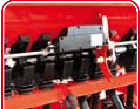
Fahrgassenschaltung Nachauflauf Tramline post emergencia Traçadores de vias de passagem para tratamentos pós-germinação
