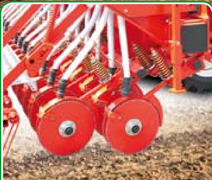
Doppelscheibenschar mit einstellbarer Druckfeder Subsolador de doble disco con resorte de compresión regulable Assulcador de duplo disco com mola de compressão regulável
