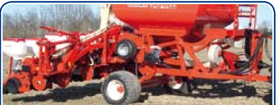
Breitreifen für eine reduzierte Bodenverdichtung Neumáticos de sección ancha para una compactación reducida Pneus de secção larga com compactação reduzida
