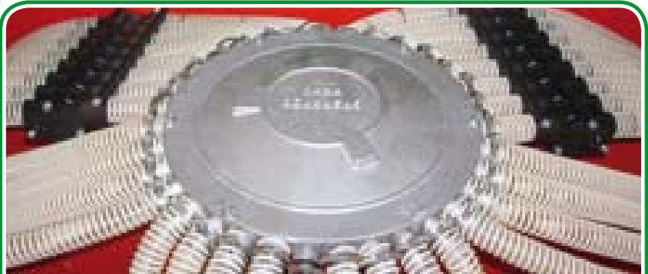
Radialer Verteiler mit Saatstromteiler für die Seitenflügel - Distribuidor radial con parcializador alas laterales - Distribuidor radial com parcializador asas laterais
